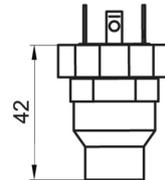
Boîtier avec connecteur DIN EN 175301-803 A (DIN 43650 A), 4 pôles
