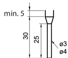
Embout du capteur réaction rapide
