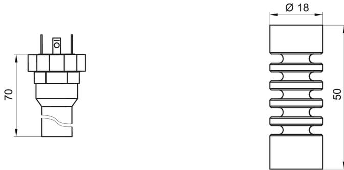
Boîtier avec transmetteur de mesure et connecteur DIN EN 175301-803 A (DIN 43650 A), 4 pôles
