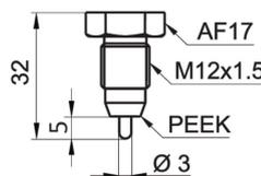
M12 x 1.5 hygiénique, PEEK cône, embout Ø 3 x 5 mm (BCID: A02)
