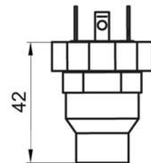
Gehäuse mit Steckverbindung DIN EN 175301-803 A (DIN 43650 A), 4-Pin
