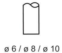
Embout du capteur réaction normale
