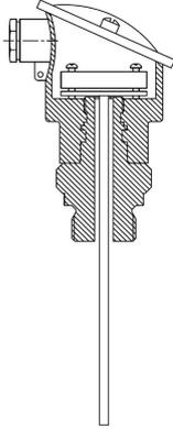
Avec insert DIN 43762, sans tube d'immersion
