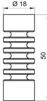
Boîtier avec transmetteur de mesure et connecteur DIN EN 175301-803 A (DIN 43650 A), 4 pôles
