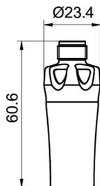
Boîtier avec transmetteur de mesure Dual Channel et connecteur M12-A King Crown, 4 pôles (avec LED)
