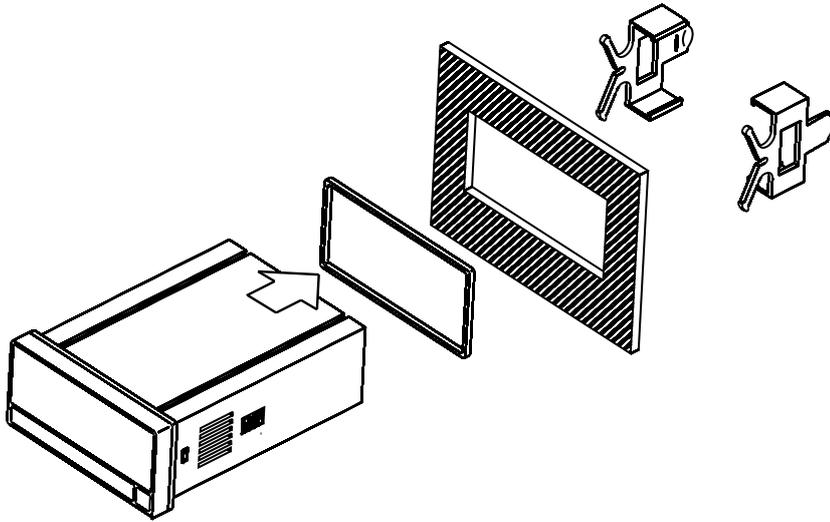
Spannrahmenmontage (Dichtung und Spannrahmen im Lieferumfang enthalten)
