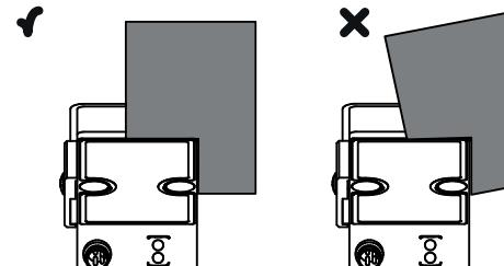
**AVIS! Les objets brillants et réfléchissants peuvent provoquer des interférences.** Inclinez les surfaces brillantes de >7° vers la face avant du détecteur.
