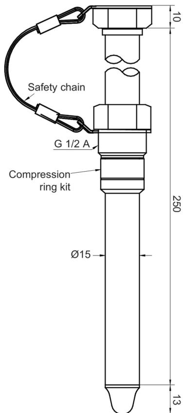
G 1/2 A hygiénique, raccord coulissant, 250 mm ajustable, avec kit de compression ZPX1-006 (BCID: A03)
