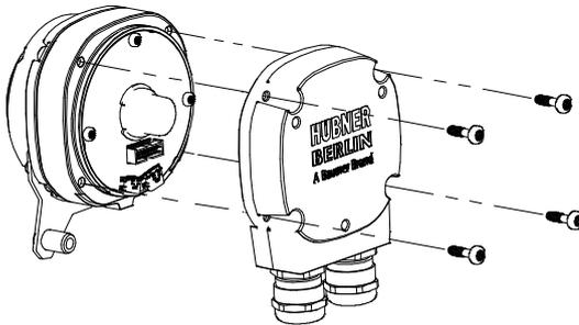
Abb. 13: Klemmenkasten demontieren
