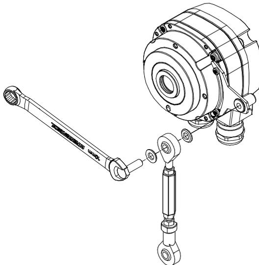
Abb. 3: Drehmomentstütze demontieren
