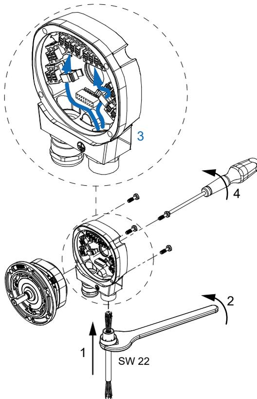
Abb. 8: Kabel anschliessen
