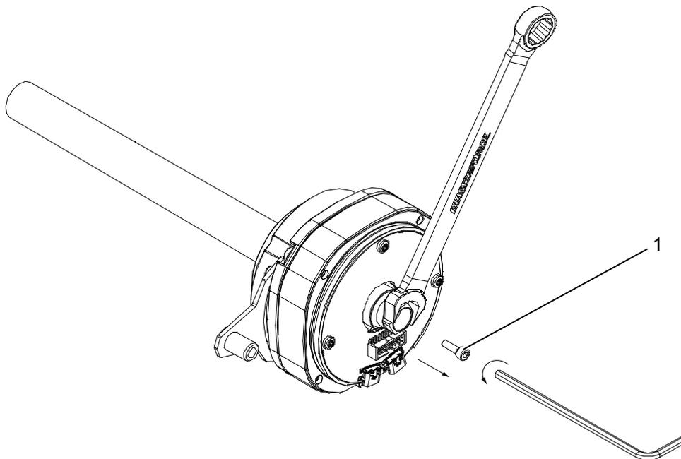
Abb. 15: Zylinderschraube demontieren
