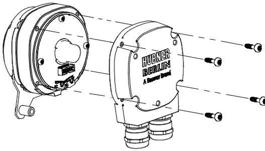
Abb. 4: Klemmenkasten demontieren
