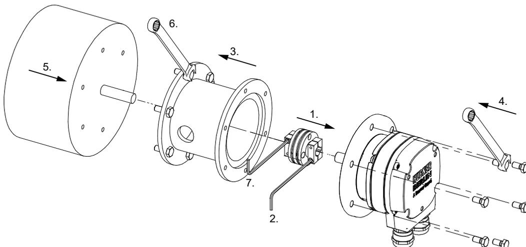
Abb. 6: Drehgeber montieren
