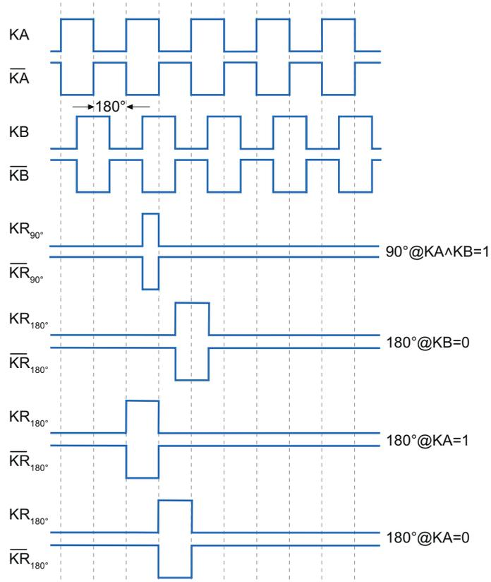
Abb. 11: Ausgangssignale bei positiver Drehrichtung
