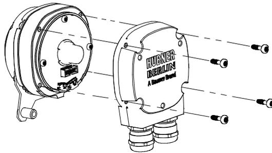
Abb. 12: Klemmenkasten montieren
