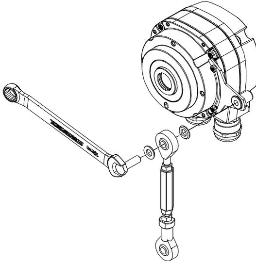
Abb. 14: Drehmomentstütze demontieren
