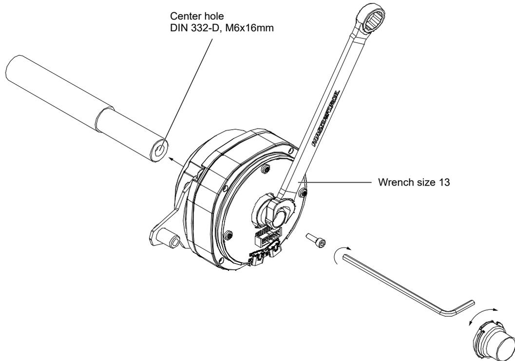
Abb. 5: Drehgeber montieren
