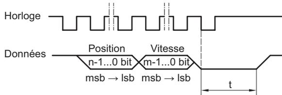
Fréquence d'horloge 100 kHz...2 MHz
