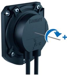
En installant l'inclinomètre unidirectionnel, veiller à ce que l'axe de rotation soit en position horizontale, veut dire perpendiculaire à la gravité comme indiqué sur l'illustration. Maximum désalignement angulaire  $\pm 3^\circ$ .
