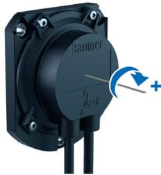
Bei der Installation von 1-dimensionalen Neigungssensoren ist darauf zu achten, dass sich die Drehachse wie in der Abbildung gezeigt in einer horizontalen Position befindet, senkrecht zur Erdanziehung. Maximale Fehlausrichtung  $\pm 3^\circ$ .
