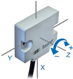
Der 1-dimensionale Neigungssensor muss so angebracht werden, dass die im Bild angezeigte Drehachse senkrecht zur Erdanziehung ausgerichtet ist. Die maximale Abweichung darf nicht mehr als  $\pm 5^\circ$  betragen. Im Auslieferungszustand des 1-dimensionalen Sensors ist die  $0^\circ$  Lage wie im folgenden Bild eingestellt.
