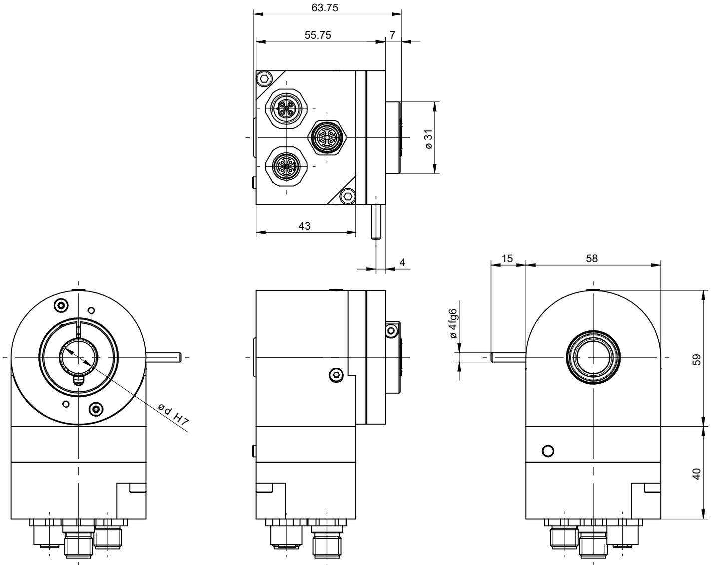
EN580C.ML-T - 3xM12, Option MTQ003: Drehmomentstift, Klemmring flanschseitig
