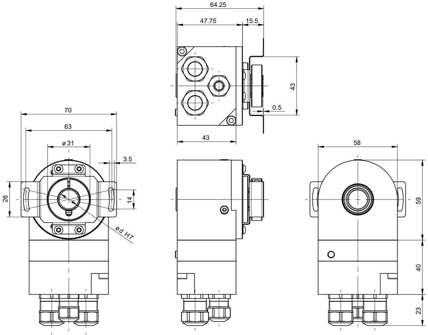
EN580C.ML-T - Kabelverschraubung, Klemmring flanschseitig, Zubehör Statorkupplung 11721627
