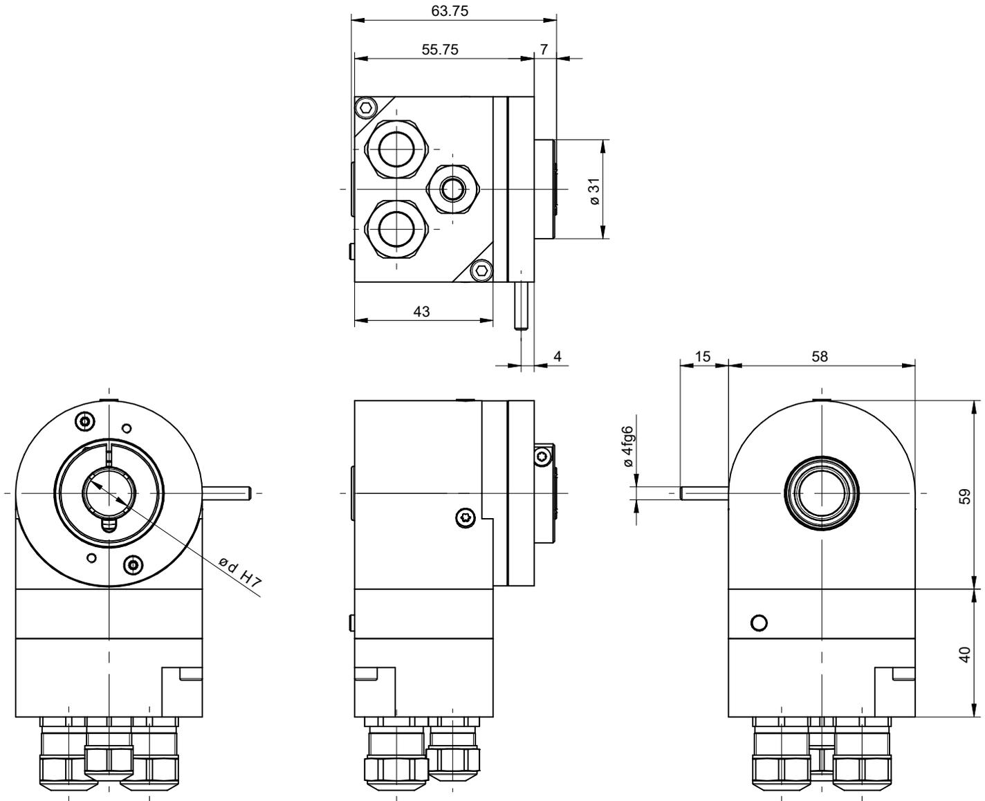
EN580C.ML-T - Kabelverschraubung, Klemmring flanschseitig, Option MTQ003: Drehmomentstift
