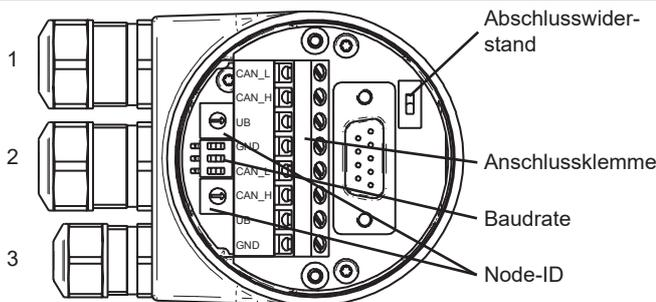
Kabel: 1, 2 =  $\varnothing$ 8-10 mm (-40-85 °C) /  $\varnothing$ 5-9 mm (-25-85 °C)
