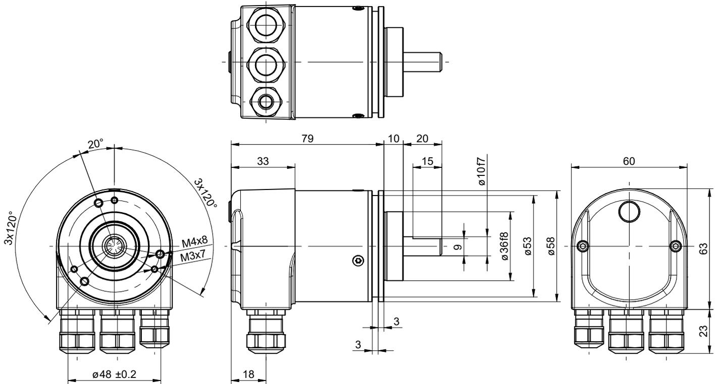
EN580C.ML-SC - Kabelverschraubung
