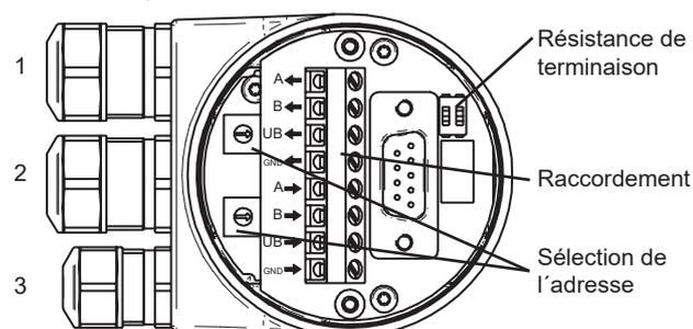
Câble: 1, 2 =  $\varnothing$ 8-10 mm (-40-85 °C) /  $\varnothing$ 5-9 mm (-25-85 °C)
