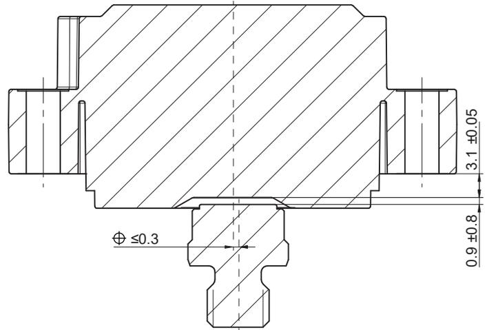
Der ideale Arbeitsabstand des Magneten zum Drehgeber ist bei einer Exzentrizität von 0 mm und einem axialen Abstand von 0,9 mm. Die Auswirkung auf die Genauigkeit bei Abweichung kann in folgendem Diagramm entnommen werden.
