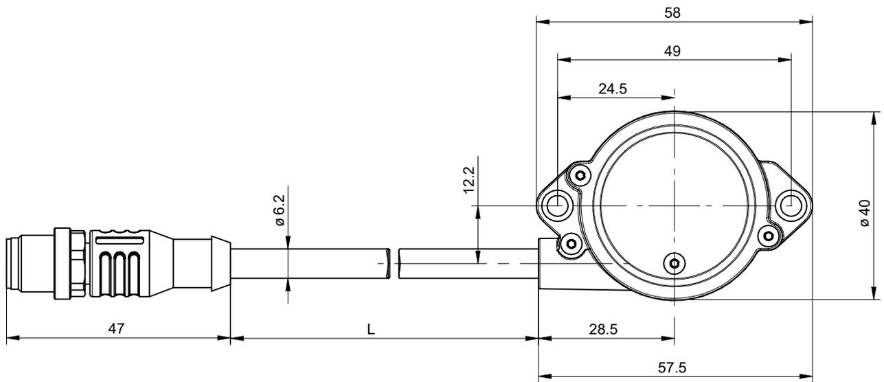
Sensor mit Kabelstecker M12
