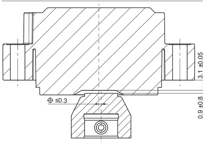
La distance de travail idéale de l'aimant par rapport au codeur est à une excentricité de 0 mm et une distance axiale de 0,9 mm. La déviation affecte la précision comme le montre le diagramme suivant.
