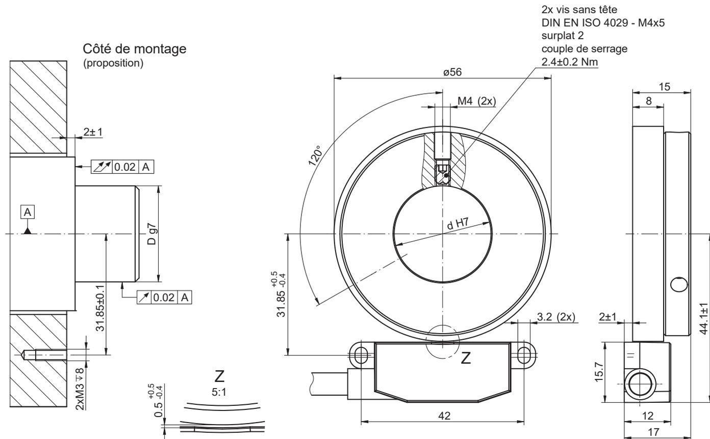
EB200E.IR-FN avec EBS.R-FN064.S pour montage à vis
