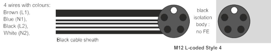
Abb. 15: [4]: Auszug aus der "PROFINET Cabling and Interconnection Technology"
