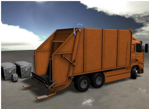
Bild 6: Kontrolle des Neigungswinkels der Ladeeinrichtung von Müllwagen mit magnetischen Winkelsensoren
