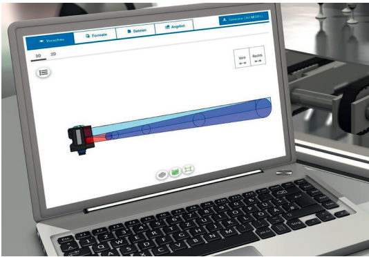
Imagen 4: El recorrido del haz está integrado en los datos CAD en 3D. Esto facilita el camino desde el Design-In hasta el montaje, puesto que el sensor se puede montar exactamente igual a como se construye, sin necesidad de un ajuste preciso.
