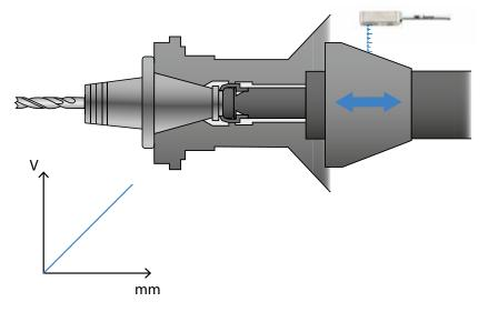
Der miniaturisierte Analogsensor erfasst die Position der Zugstange durch unterschiedliche Abstände beziehungsweise Spannungswerte zum Steilkegel, welche in der Steuerung ausgewertet werden. Damit werden die drei Zustände des Spannfutters an die Steuerung weitergegeben.
