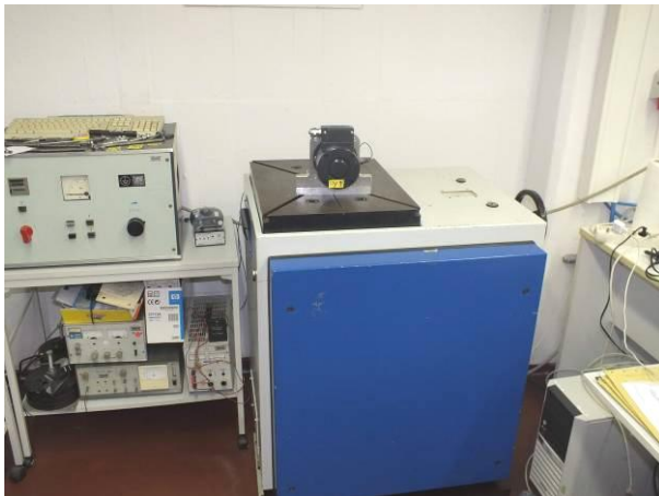
Bild 9 Drehgeber POG 9 auf dem Stoßtisch mit Beschleunigungssensor beim Schocken in der Y-Achse, positive Richtung
