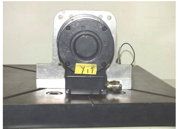
Bild 10 Drehgeber POG 9 auf dem auf dem Stoßtisch mit Beschleunigungssensor beim Schocken in der Y-Achse, negative Richtung
