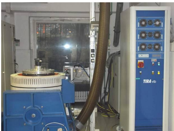
Bild 5 Drehgeber POG 9 auf der Schwingprüfanlage beim Schwingen in der Z-Achse
