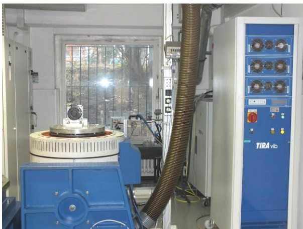
Bild 3 Drehgeber POG 9 auf der Schwingprüfanlage beim Schwingen in der Y-Achse
