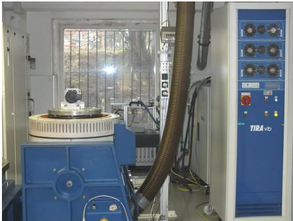
Bild 1 Drehgeber POG 9 auf der Schwingprüfanlage beim Schwingen in der X-Achse
