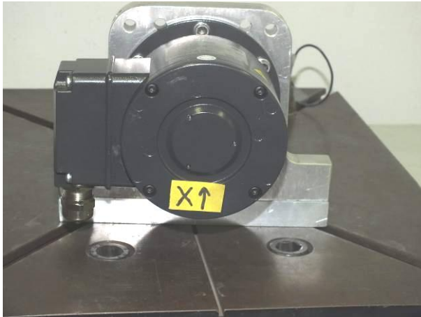
Bild 7 Drehgeber POG 9 auf dem Stoßtisch mit Beschleunigungssensor beim Schocken in der X-Achse, positive Richtung
